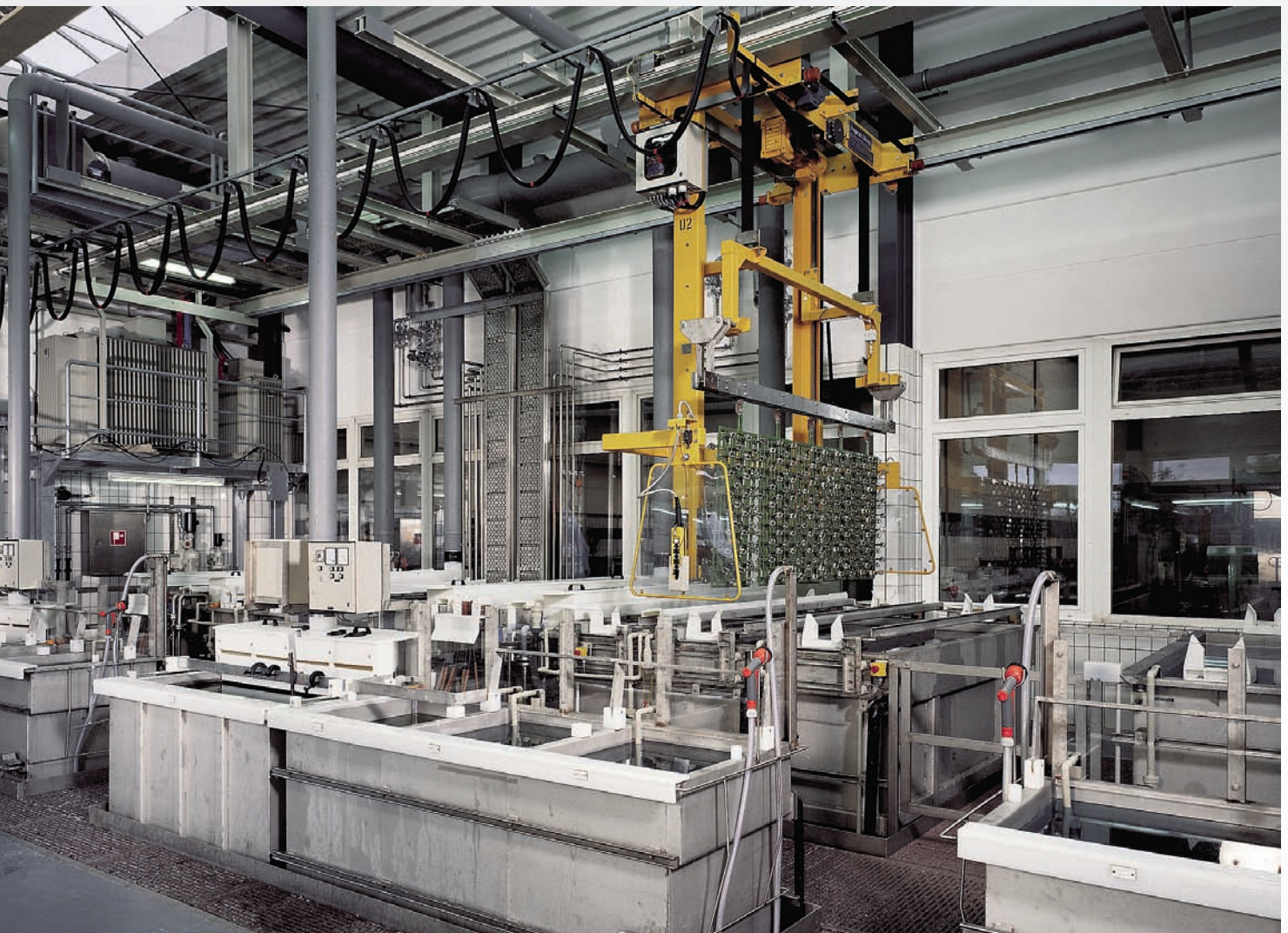
Elektropolier-Automat mit davor befindlicher manueller Anlage Automatic electropolishing plant with manual plant in front
