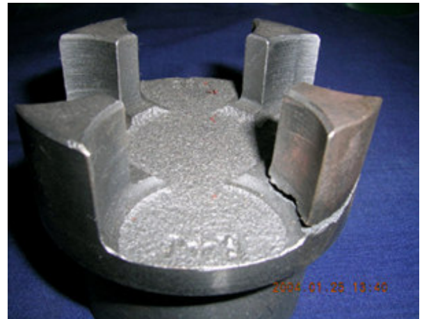
b) การหักของซี่เขี้ยวคูมที่เกิดจากการ กระแทกกระท่างซี่เขี้ยวด้วยกัน
