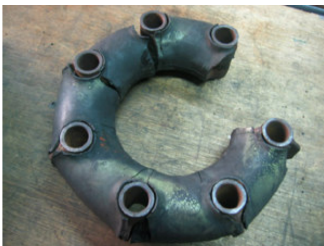
รูปที่ 4.1 ลักษณะความเสียหายของชิ้นส่วนอ่อนตัวเนื่องจากภาระแรงบิดเกินกำลัง
