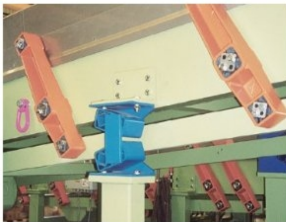
2.2.2 (ค) สปริงโรสต้าสำหรับงานขนถ่ายวัสดุด้วยรางเขย่าทั้งแบบขับเคลื่อนด้วยน้ำหนักและข้อเหวี่ยง [6]
