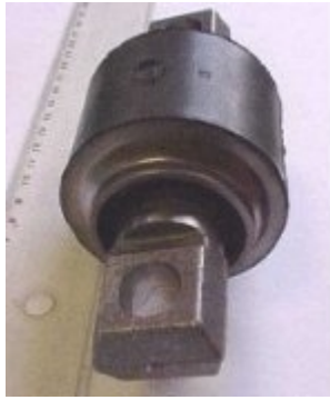
รูปที่ 2.2.1 (ง) สลักยางทรงกลม (Spherical rubber bush) เพื่อการรับแรงที่สูงขึ้นรวมถึงทำหน้าที่ fail-safe คือแม้เนื้อยางจะเสียหายแต่ยังใช้งานได้ต่อเนื่องโดยที่แกนสลักไม่หลุดออกมา[5]
