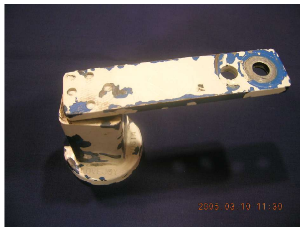
รูปที่ 9 ลักษณะแกนตึงโซ่/สายพานหมดอายุการทำงาน จากการเกิด coldflow [3], [4]
