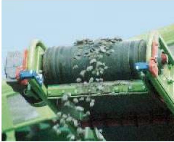
รูปที่ 6 การใช้งาน โมดูลสปริงโรสต้าสำหรับกวาดสายพาน
