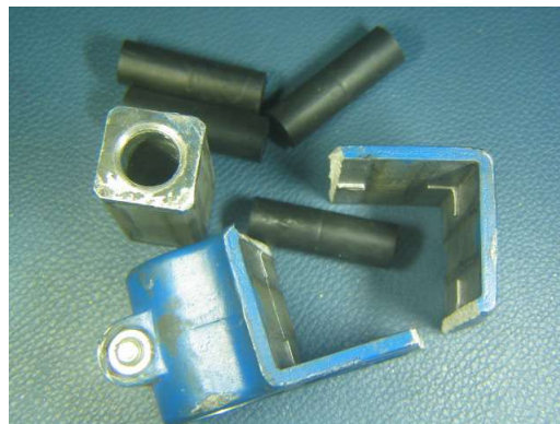
รูปที่ 12 ความเสียหายที่เกิดการะเกินกำลัง [6]
