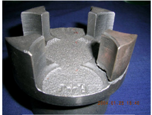
b) การหักของเขี้ยวคูลมที่เกิดจากการ กระแทกกระท่างเขี้ยวด้วยกัน
